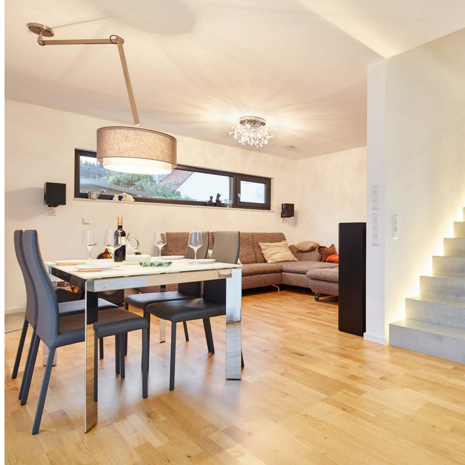
Das Dreischicht-Parkett aus Echtholz verfügt über eine Nuttschicht aus Naturholz, eine Mittellage, die aus hochdichten Faserplatten oder Echtholz bestehen kann, und dem sogenannten Gegenzug, der für Belastbarkeit sorgt.
